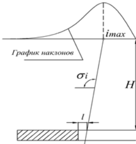
Рис. 5. Схема к определению местоположения выработанного пространства по характерным точкам мвльды свлижения.
